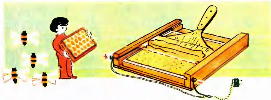
полотна и проволоки большого сопротивления, через которую пропускается ток напряжением до 6—12 в.
