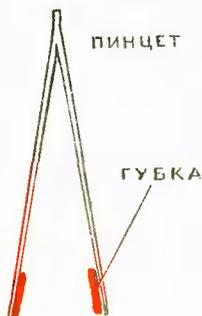
На зажимы пинцета, которыми деталь придерживают во время пайки, наклеиваются полоски поролона. Перед тем как начать монтаж, пинцет нужно окунуть в воду. Испаряясь с поролоновых подушечек, она вызовет охлаждение детали, помещенной между ними. Такой пинцет-холодильник придется по душе всем радиолюбителям.
